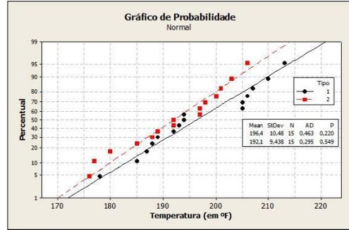
Figura 2 - Gráfico de probabilidade normal das temperaturas de deflexão.
