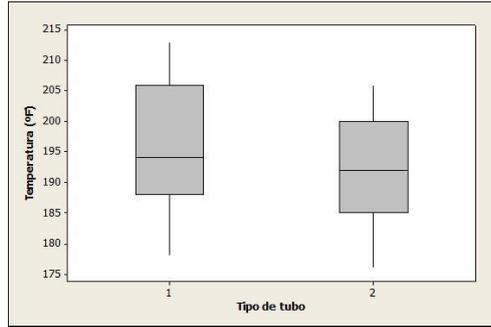
Figura 1 – Box-plot das temperaturas de deflexão.
