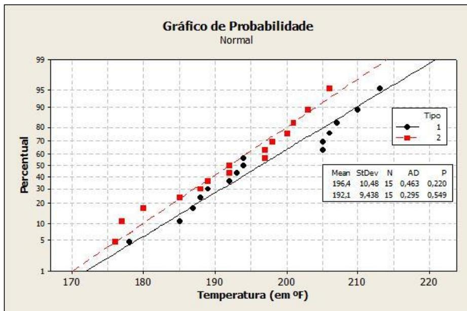
**Fig. 2 - Gráfico de probabilidade das temperaturas de deflexão (Ex. 5).**
