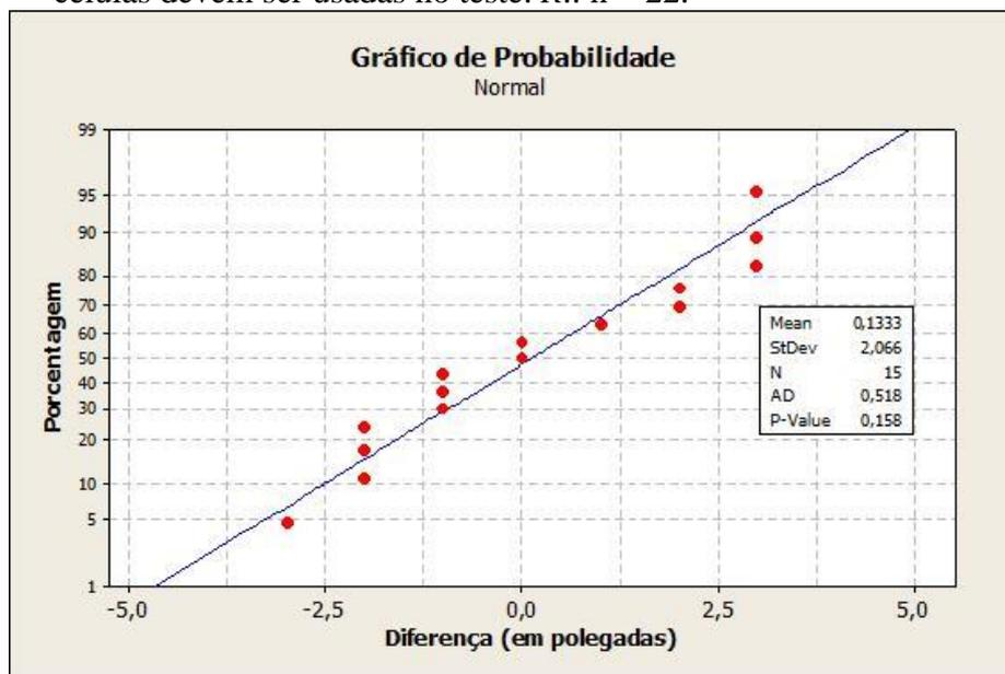
Figura 7 - Gráfico de probabilidade normal das diferenças de profundidade (em pol.)
