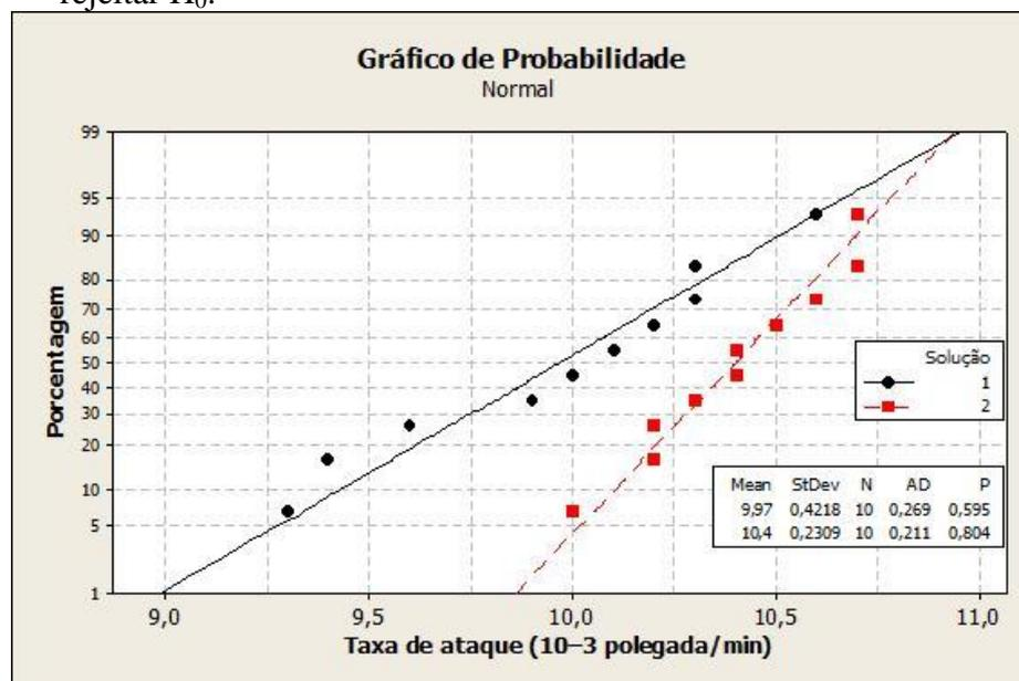
Figura 3 - Gráfico de probabilidade das taxas de ataque (em  $10^{-3}$  polegada/min)
