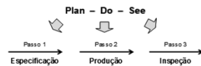
Figura 1: Conceito de controle de Taylor e os três processos de produção em massa. Fonte - Moen e Norman (2007).
